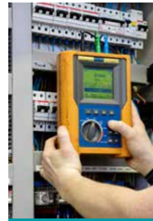
Controle van aardlekschakelaars door foutstroom naar aarde.
