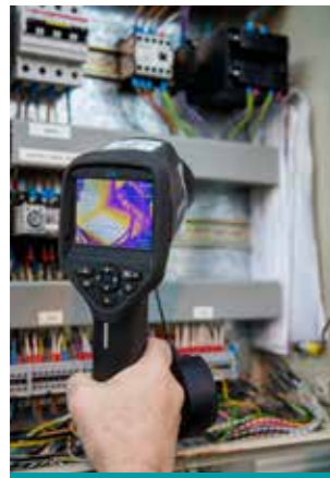
Doormeten van hoofd- en onderverdeelinrichtingen met warmtebeeldcamera.
