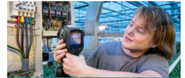
Meting met warmtebeeldcamera onderverdeelinrichting
